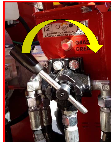
Afbeelding 25: hendel handpomp op stand herstel stempelpoten.
