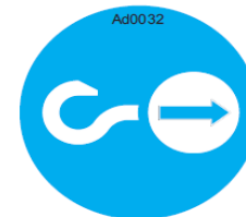
Afbeelding 62: aanduiding koppeling onderstel voor vervoer hoogwerker.
