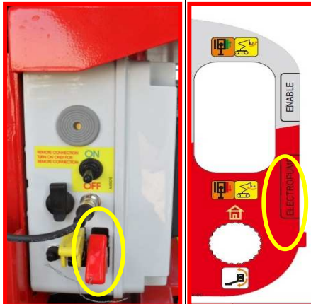
Afbeelding 29: knoppen elektrische pomp.
