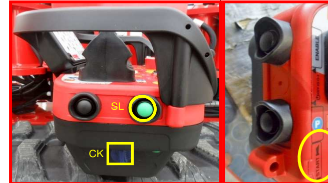
Afbeelding 7: contactsleutel en knop koppeling afstandsbediening.
